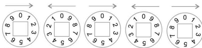
No medidor de ponteiros, inicie a leitura da direita para a esquerda
